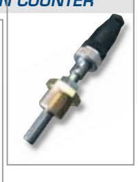
Sensore di prossimità induttivo completo di connettore femmina M12, 4 pin, IP67, a cablare, con ghiera montaggio M18 x 1 - Alimentazione 12/24 VDC Inductive proximity sensor, c/w female connector M12 4 pin, IP67, field attachable, ring nut reduction M18 x 1 - Power supply 12/24 VDC
